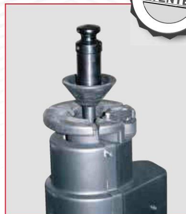
ELEKTRO - MECHANICKY UPÍNACÍ OTOČNÝ STŮL s elektronickým ovládáním
